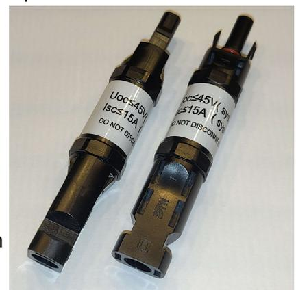
Pro parallel angeschlossenem Modul brauchst Du einen Diodenstecker, in dem Beispiel hier also vier Stück. Die beiden Stecker im Bild „vertragen“ dabei einen maximalen Strom von 15 Ampere und halten eine Sperrspannung von 45 Volt aus.
