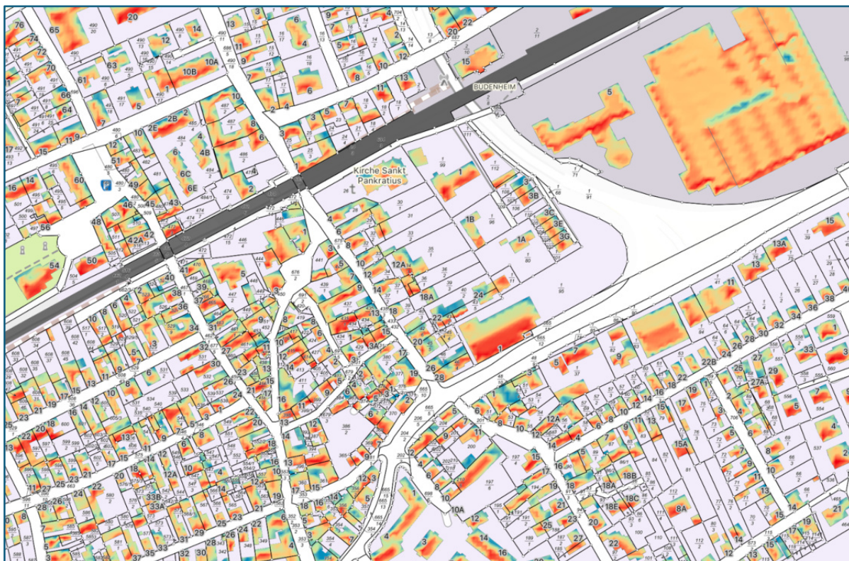
Abbildung 30: Beispielhafter Auszug von solarthermischen Eignungsgebieten (Dachflächen).
